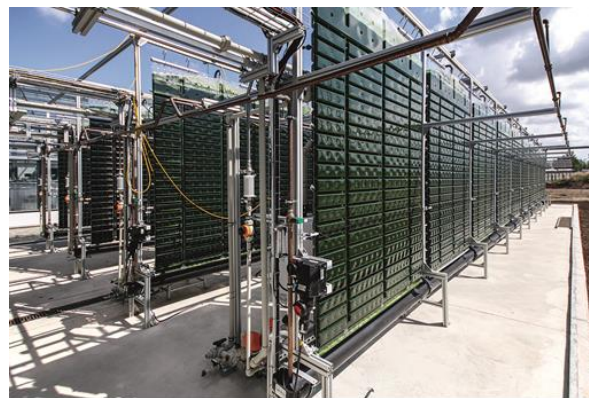
Рис. 5. Фотобиореакторы для одновременного производства биотоплива и очистки воды [111]
