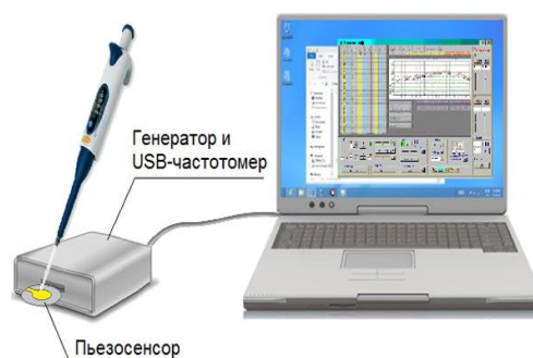
Рис. Схема установки для определения сорбата калия и бензоата натрия [29]
