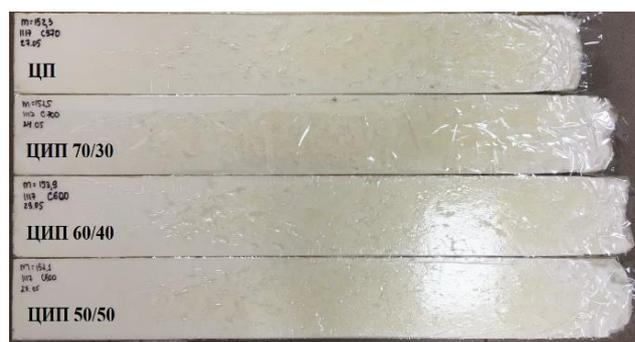
Рис. 1. Заливка образцов с различными вспенивающими агентами в форму на определение текучести пены (все образцы имеют одинаковую массу заливки)
