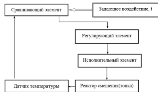
Рис. 3. Функциональная схема САУ топочным устройством Fig. 3. Functional diagram of the ACS with a combustion device
