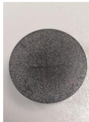
Рис. 2. Вид образца после шлифовки и полировки
