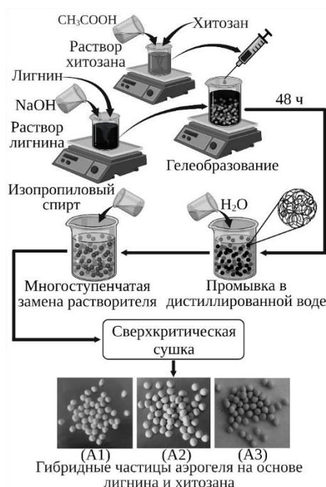
Рис. 2. Схема синтеза гибридных частиц аэрогеля на основе лигнина и хитозана
