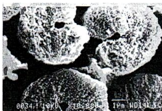
Рис. 4. Микроструктура углепластика на основе полиарилсульфона и углеродной ленты ЭЛУР 0.08ПА – торцы волокон ( \times 10\ 000 )
