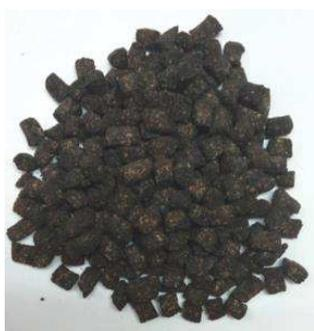
Рис. 2. Фотография гранул NPK ОМУ цилиндрической формы размером 5×6 мм
