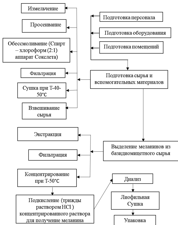
Рис. 1. Технологическая схема получения меланина из плодового тела базидиального гриба Bovista plumbea
