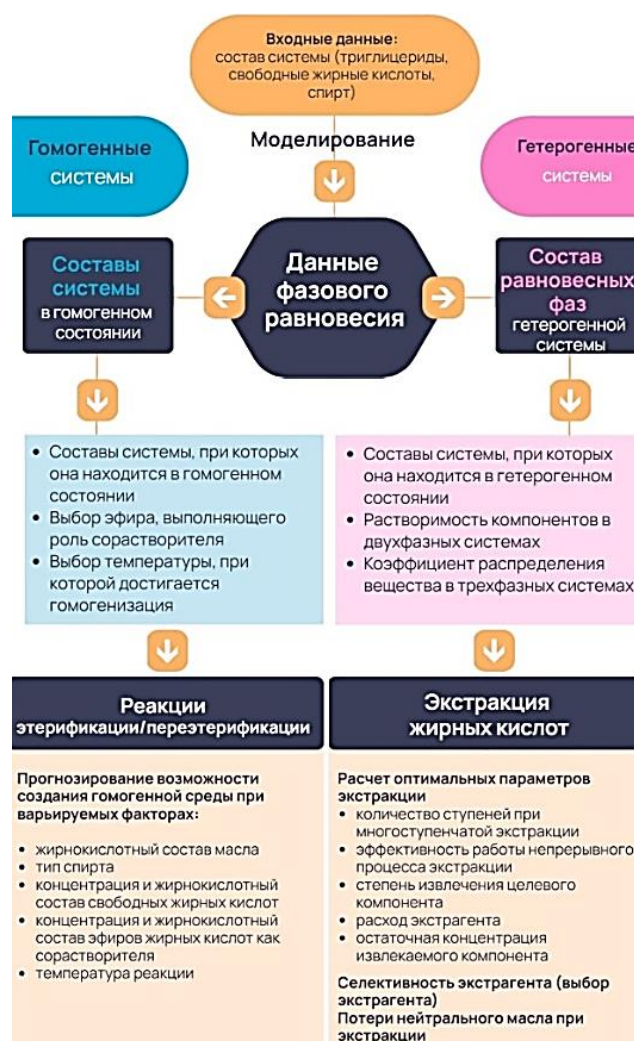
Рис. 1. Технологические параметры, получаемые по расчетам данных фазового равновесия
