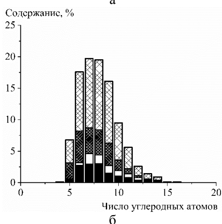
Рис. 1. Молекулярно-массовое распределение синтетической бензиновой фракции углеводородов G-01 (а) и G-02 (б) ■ n -алканы; □ изо -алканы; ▨ алкены; ▤ разв.-алкены Fig. 1. Molecular weight distribution of synthetic gasoline fractions of hydrocarbons G-01 (a) and G-02 (b) ■ n -alkanes; □ iso -alkanes; ▨ alkenes; ▤ branched alkenes
