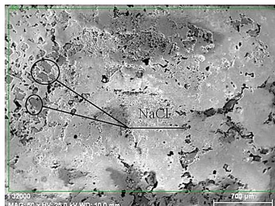
Рис. 4. Микрофотография поверхности кристалла КСl после ультразвуковой обработки ( $I = 40$  Вт/см<sup>2</sup>,  $\tau = 60$  с), при увеличении 50X
