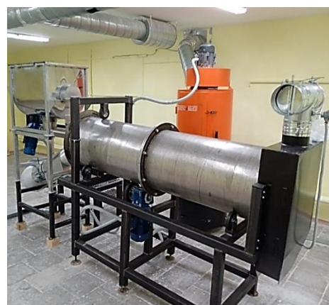
Рис. 1. Модельная установка по нанесению покрытий
