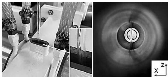
Рис. 3. Размещение нити УНТ вдоль направления Z для исследования воздействия магнитного поля излучения Fig. 3. Placement of the CNT fiber along the direction Z for studying the effect of the magnetic field of radiation
