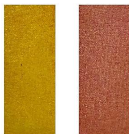
Рис. 4. Фотографии тест-полосок соединения 3a до и после погружения в раствор, содержащий катионы Hg^{2+} ( c_{кат} = 5,0 \cdot 10^{-5} моль/л)
