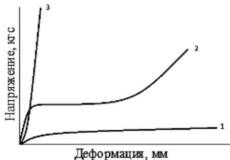
Рис. 2. Деформационные кривые, соответствующие характеру поведения высокоэластичных (1), среднеэластичных (2) и твердых (3) полимеров
