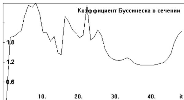
Рис. 9. Коэффициент Буссинеска для сечения трубопровода вблизи узла сочленения (координата сечения  $i = 7$ )
